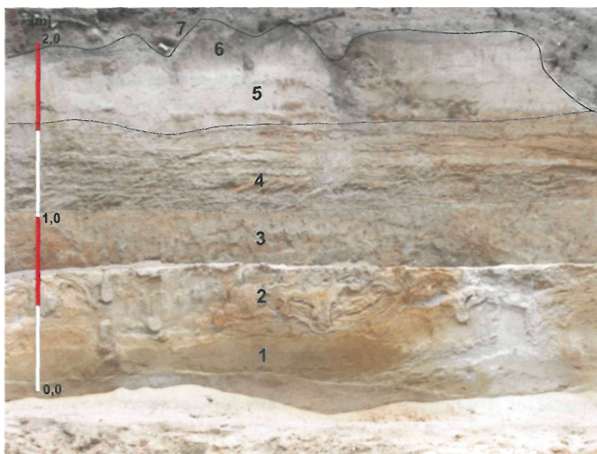
Ryc. 5. Wrocław. Profil geologiczny stropowej części osadów rzecznych, piasków eolicznych i gleby na Starym Mieście (pl. Dominikański skrzyżowanie ulic Kołłątaja i Kazimierza Wielkiego): 1 - piaski rzeczne akumulowane na równi zalewowej; 2 - piaski rzeczne zaburzone w warunkach klimatu peryglacialnego; 3 - piaski rzeczne akumulowane na równi zalewowej; 4 - piaski korytowe; 5 - piaski eoliczne; 6 - poziom mineralno-próchniczny (tzw. poziom gleby pierwotnej); 7 - nasypy antropogeniczne
